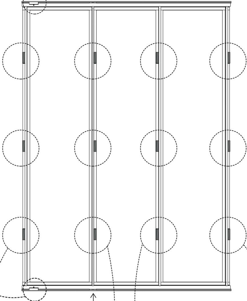
Glisser l'autre butée dans le rail du profil C, du côté de l'encoche.
