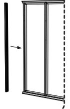
Glisser une butée dans le rail du profil B, du côté de l'encoche.
