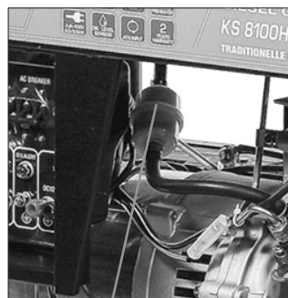
Filtre à carburant
