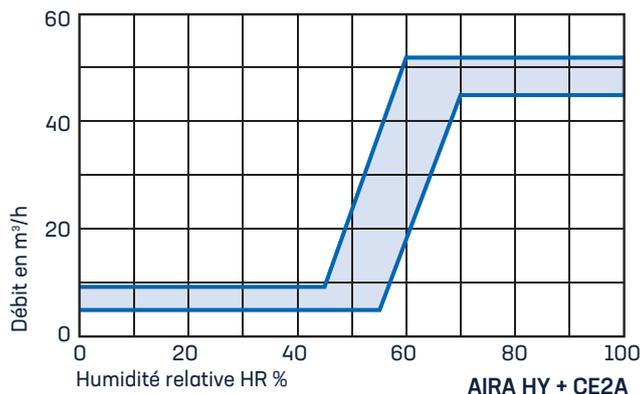
La courbe ci-contre donne les caractéristiques aérauliques nominales en fonction du taux d'humidité de l'air intérieur et pour une différence de pression de 20 Pa.
