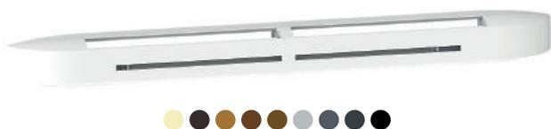
L'entrée d'air assure un débit variable de 5 à 45 m<sup>3</sup>/h en fonction du taux d'humidité de la pièce et pour une différence de pression de 20 Pa.
