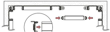
Glisser les SL-RCA180 dans les SL-RCF90. Serrer les vis tête fraisée avec une clé hexagonale de 3mm..
