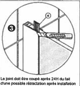
Le joint doit être coupé après 24H du fait d'une possible rétraction après installation
