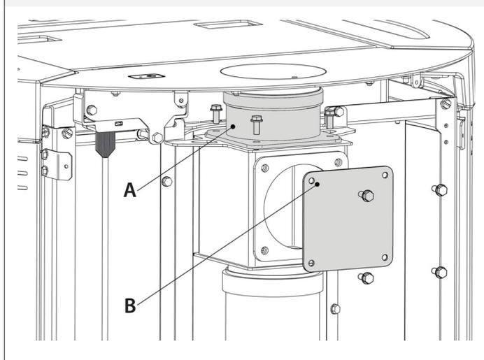
4. Placer le cache (B) précédemment enlevé et le fixer sur le trou supérieur. Fixer le raccord femelle (A) sur le trou arrière.
