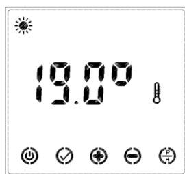
**Mode Confort :** la température par défaut est de 19°C. Appuyez sur
