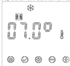
fenêtre ouverte et l'appareil passe en mode Hors-gel alors que ceci s'affiche sur l'écran. Le chauffage reprend automatiquement au bout de 65 minutes. Cependant, vous pouvez le rallumer manuellement avant ce délai en appuyant sur
