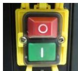
Para arrancar pulse el botón verde «I» en el interruptor de encendido-apagado.
