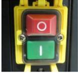
Drücken Sie zum Starten der Maschine am Ein-Aus-Schalter die grüne Taste "I".
