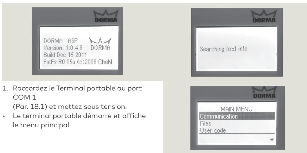
1. Raccordez le Terminal portable au port COM 1 (Par. 18.1) et mettez sous tension.
