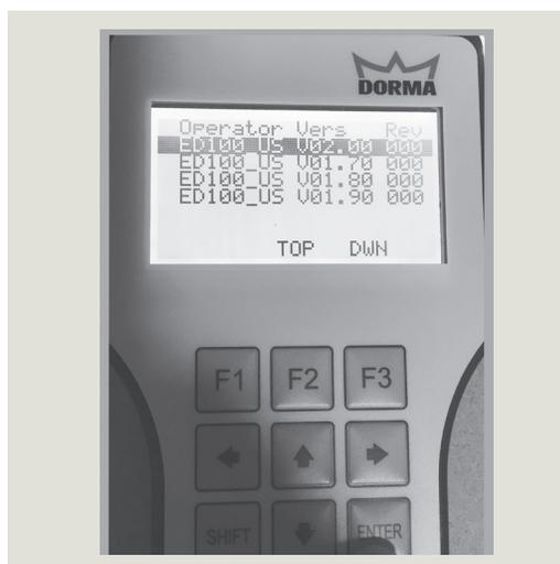
6. Utilisez les flèches Haut et Bas pour sélectionner la version du firmware et appuyez sur ENTER.
