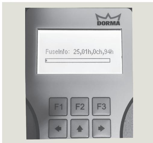
8. Téléversement du firmware vers le contrôleur. Temps d'attente de 3 à 5 minutes avant téléversement.
