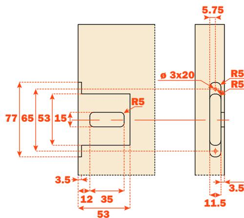
**Conecta • Montage • Porte simple avec insert DQG5B**
