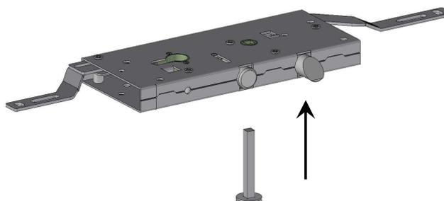
6) Remonter le boîtier de serrure sur le bandeau et le bloquer avec les 4 vis de fixation.
