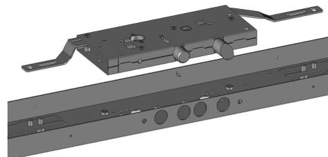
2) Montage du protecteur de cylindre avec les 4 vis M5x16. Attention au sens pour une serrure à gauche. **Pour la version A2P mettre la plaque intermédiaire.**
