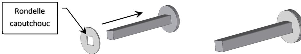
4) Montage du carré sur le boîtier de serrure. **ATTENTION** au sens de montage en fonction de la main de la serrure
