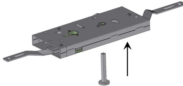
5) Remonter le boîtier de serrure sur le bandeau et le bloquer avec les 4 vis de fixation.
