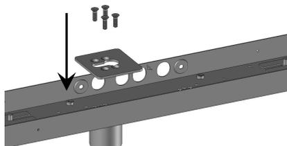
3) Montage de la rondelle caoutchouc sur le carré.
