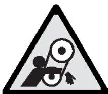
Ne pas s'approcher ni toucher les organes mécaniques en mouvement, spécifiquement ceux de la transmission (engrenages, poulies, etc.) Le contact peut provoquer de graves accidents
