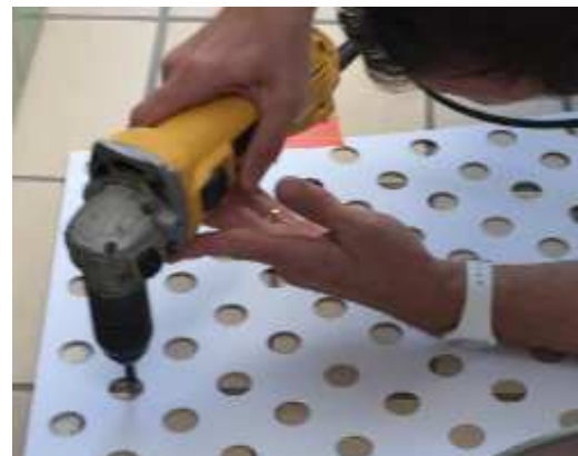
Perceuse équipée d'un mandrin à 90° et d'un trépan pour carrelage
