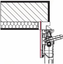
Placer la machine dans la feullure ou sur le cochonnet et découper le cadre en bois
