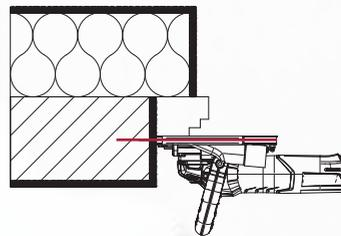
Découpe droite d'une profondeur de 60 mm
