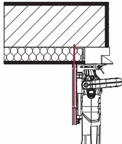
Placer la machine dans la feullure et découper le mur
