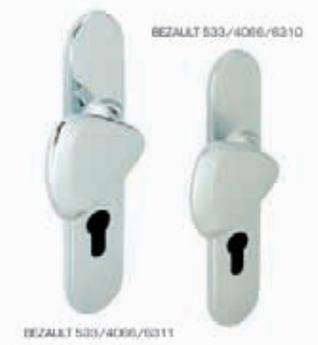
Ensemble complet plaques et béquilles solidarisées avec carré de 7 mm et vis, pour portes épaisseur standard de 40 mm et serrure entraxe à 70 mm (carré de 8 mm, autres épaisseurs et entraxes sur demande) - Poignée de tirage réversible - Fixation invisible côté extérieur par 2 vis M4 traversantes - Ressorts de soutien de béquille en option - Finitions : chrome miroir, chrome velours, Soléco
