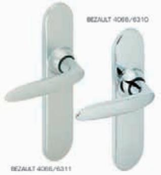
Ensemble complet plaques et béquilles solidarisées avec carré de 7 mm et vis, pour portes épaisseur standard de 40 mm et serrure entraxe à 70 mm (carré de 8 mm, autres épaisseurs et entraxes sur demande) - Fixation invisible côté extérieur par 2 vis M4 traversantes - Ressorts de soutien de béquille en option (permet la contre-levée sur les serrures multipoints) - Finition : chrome miroir, chrome velours, Soléco
