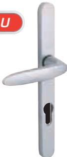
Ensemble béquilles et plaques solidarisées pour porte en profils aluminium ou PVC. Plaque étroite largeur 24 mm. Pour porte épaisseur 58 à 70 mm, serrure à entraxe 70 mm avec carré de 7 mm (autres épaisseurs, entraxe et carré : à préciser à la commande). Finitions chrome miroir, chrome velours ou Soleco
