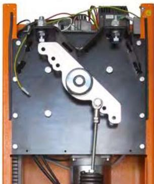
**Ressorts d'équilibrage** - à grande tenue, garantis jusqu'à 2 000 000 de manœuvres pour les modèles M-Bar et L-Bar.
