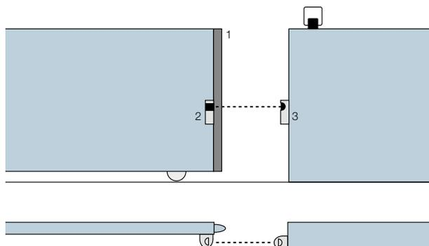
**Dispositifs optiques, avec émetteur sans fil pour fixation sur vantail mobile, orientable sur 210° le long de l'axe horizontal et sur 30° le long de l'axe vertical, pour une installation parfaitement aux normes.**
