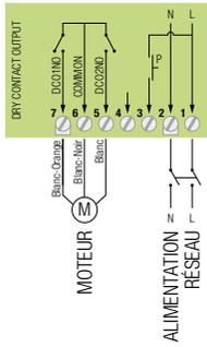
Raccordements des sorties pour moteurs mécaniques à 3 fils
