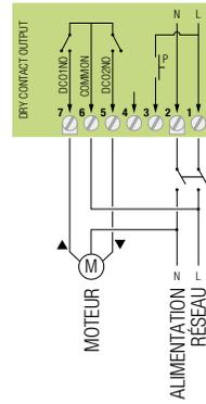
Raccordements des sorties pour 2 commutateurs indépendants
