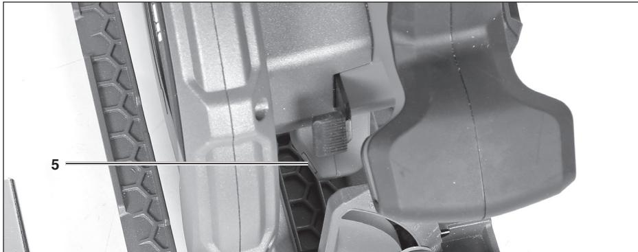
**D** Wird die Maschine überlastet, schaltet diese zum Schutz ab und das LED-Licht (5) fängt an zu blinken (5x, dann 1 Sekunde Pause). Lassen Sie das Gerät abkühlen. Anschließend kann das Gerät wieder normal verwendet werden.
