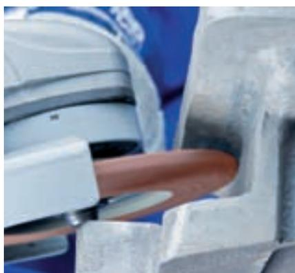
Outil haute performance en exécution PFERD SGP CURVE-ALU pour des travaux de meulage exigeants. Parfaitement adapté à l'usinage de l'Aluminium. Pas d'encrassement de l'outil sur des matériaux tendres et encrassants.
