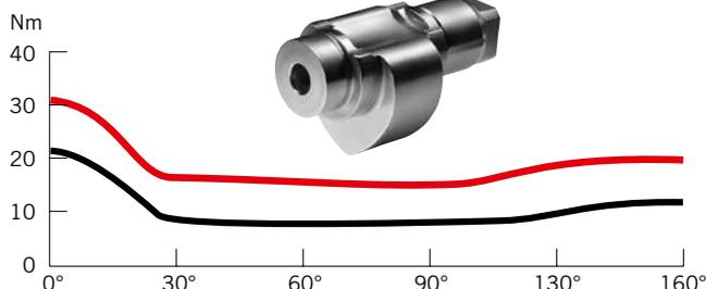
La came symétrique en forme de coeur et l'entraînement linéaire du TS 90 Impulse DORMA offrent à l'utilisateur un grand confort d'utilisation grâce à une résistance à l'ouverture immédiatement dégressive. Pour les enfants, les personnes âgées et les handicapés, ouvrir
