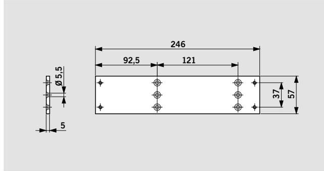
Avec groupe de perçage universel, pour la pose sur profil tubulaire (acier ou aluminium).
