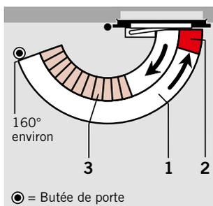
Les réglages hydrauliques sont ajustables en continu par trois vis indépendantes l'une de l'autre.
