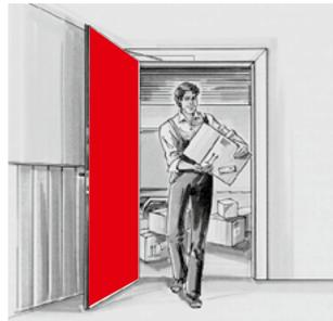
**L'arrêt mécanique n'est pas conçu pour les portes coupe-feu, pare-fumée et pare-flammes.**
