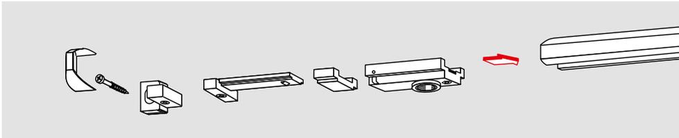
L'arrêt mécanique permet le blocage de la porte (interdit sur portes coupe-feu) à un angle précis jusqu'à un angle d'ouverture de env. 145°.
