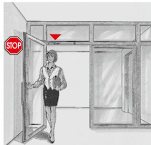
**Le limiteur d'ouverture n'est pas une protection contre les ouvertures violentes. Dans de nombreuses applications, il ne remplace pas la butée de porte, ou le freinage hydraulique à l'ouverture (TS 90 Impulse BC).**
