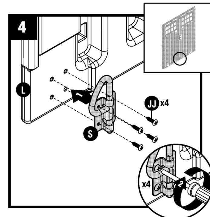
Au bas du côté intérieur de la porte gauche (L), fixez le verrou coulissant avec anneau en D (S) à l'aide de quatre vis (JJ).
