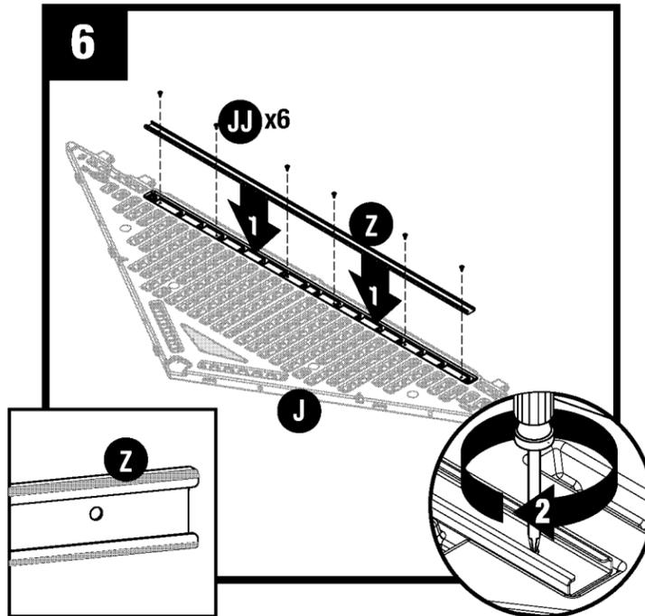
Insérez la poutre (Z) dans la cavité du chevêtre avant (J). Fixez à l'aide de six vis (JJ). **NE SERREZ PAS** les vis trop fort.
