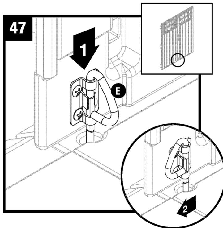
Pousser l'anneau en D (E) vers le bas pour insérer le tenon dans le trou du plancher. Tourner l'anneau en D vers la gauche pour verrouiller.
