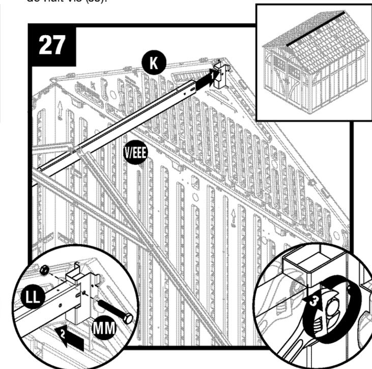
Soulevez le faitage (V/EEE) et insérez-le dans le chevêtre arrière (K). Fixer avec un boulon (MM) et un écrou (LL). Faites de même pour le chevêtre avant (J).
