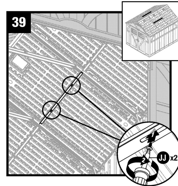
Fixez la rallonge de la barre d'appui du toit (BB) au panneau intérieur du toit à l'aide de deux vis (JJ). **Répétez les étapes 38 et 39 pour installer et fixer les barres d'appui du toit restantes aux autres panneaux intérieurs du toit.**
