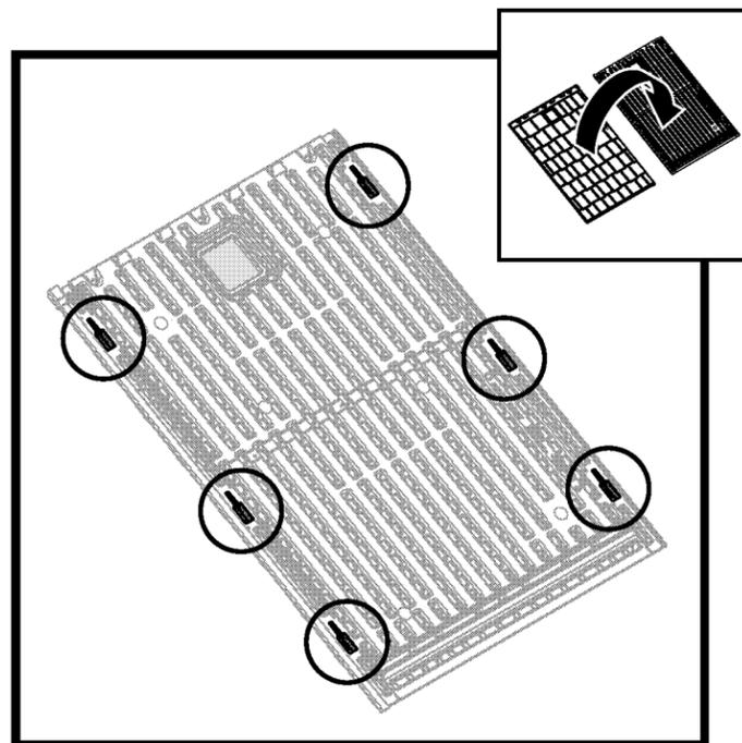
Avant de poursuivre, repérez et identifiez les six fentes qui se trouvent à l'intérieur des panneaux droits et gauches du toit.
