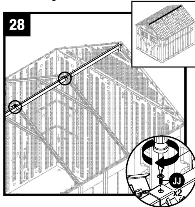
Fixez l'assemblage du toit et de la ferme au faîtage à l'aide de deux vis (JJ).
