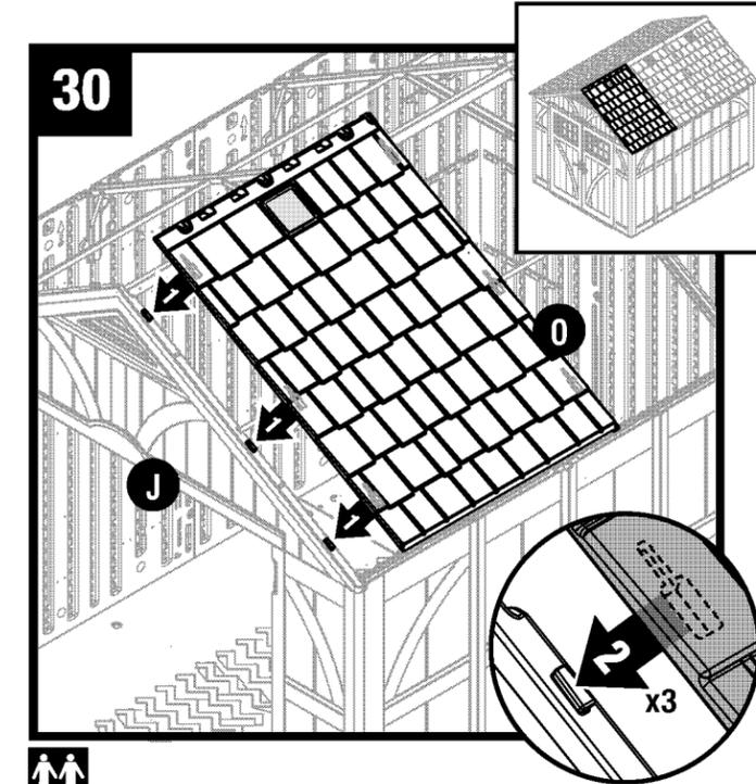
Posez la partie droite du toit (O) directement sur les trois languettes situées sur le côté droit du chevêtre avant (J). Lorsque les fentes de la partie droite du toit se trouvent au-dessus ou sur les languettes du chevêtre, vérifiez l'alignement aux trois endroits.
