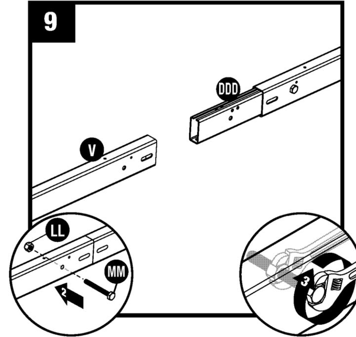
Insérez le faîtage de 2,13 m (7 pi) (V) par-dessus l'adaptateur du faîtage (DDD). Fixez à l'aide d'un boulon hexagonal (MM) et d'un écrou (LL).
