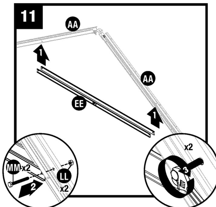
Fixez deux traverses de ferme (EE) aux deux chevrons de ferme (AA) à l'aide de deux vis à tête hexagonale (MM) et de deux écrous (LL). Soulevez la ferme et vérifiez que la traverse est à niveau.
