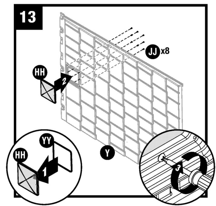
Placez le joint du lanterneau (YY) dans le lanterneau (HH). Placez le lanterneau (HH) sur le panneau droit du toit (O). Fixez par le dessous à l'aide de huit vis (JJ). Assurez-vous que les nervures des pièces en plastique sont bien en place contre le joint du lanterneau. Faites de même pour les autres panneaux du toit.
