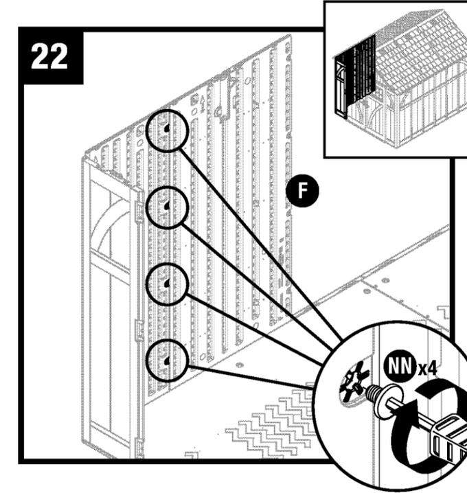
Fixez le panneau latéral (F) à l'aide de quatre boulons rapides (NN), en commençant par le plancher. **N'UTILISEZ PAS** de clé dynamométrique. Utilisez l'outil pour boulon rapide (OO) et serrez à la main. La tête du boulon rapide s'encastre une fois le boulon bien en place. **NE SERREZ PAS** les boulons rapides trop fort.
