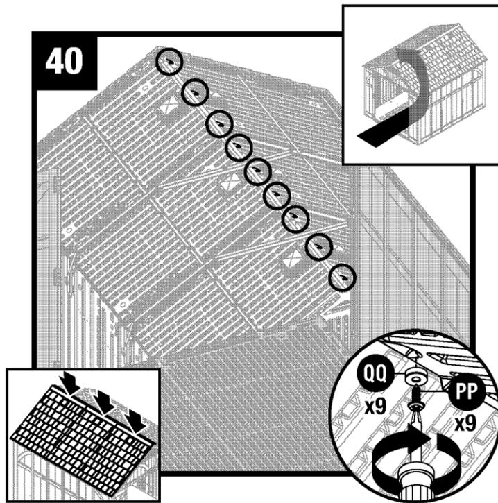
Poussez sur le toit depuis l'extérieur pour le mettre en place. À l'intérieur de la remise, fixez les panneaux du toit ensemble le long du faîtage à l'aide de neuf rondelles en caoutchouc (QQ) et neuf vis d'étanchéité (PP).
