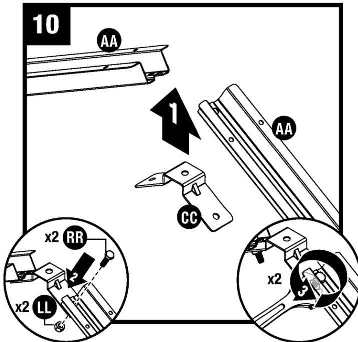
Fixez le support de ferme (CC) à l'extrémité d'un chevron de ferme (AA) à l'aide d'un boulon hexagonal (RR) et d'un écrou (LL). Faites de même avec le deuxième chevron de ferme (AA).
