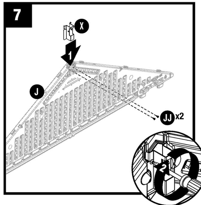
Faites glisser le toit support de poutre faîtière (X) sous des onglets sur l'intérieur pic de tête avant (J) et sécurisé avec deux vis (JJ). Ne pas trop serrer les vis. Répétez les étapes 5-7 pour-tête arrière (K)
