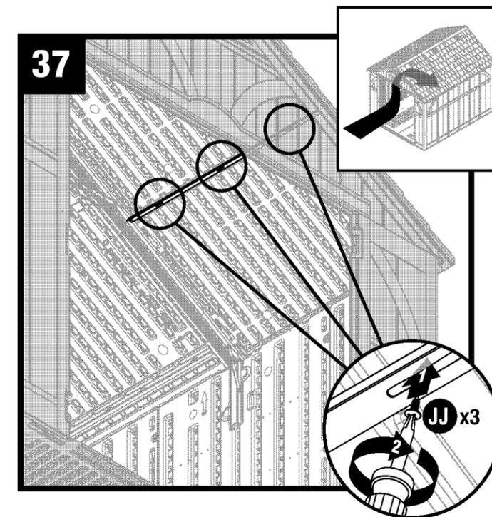
Fixez la barre d'appui du toit au toit à l'aide de trois vis (JJ). **Répétez les étapes 36 et 37 pour installer et fixer les barres d'appui du toit restantes aux trois panneaux extérieurs du toit.**
