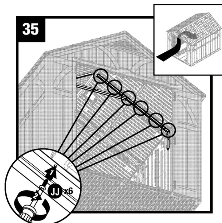
Fixez le toit à la ferme à l'aide de six vis (JJ). Chaque vis doit être fixée au bloc de fixation correspondant situé sur le toit.
