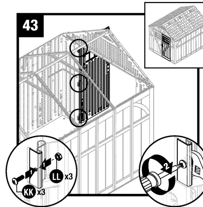
Fixez chaque plaque de charnière métallique à l'aide d'une vis (KK) et d'un écrou (LL).
