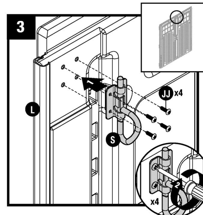
En haut du côté intérieur de la porte gauche (L), fixez le verrou coulissant avec anneau en D (S) à l'aide de quatre vis (JJ).
