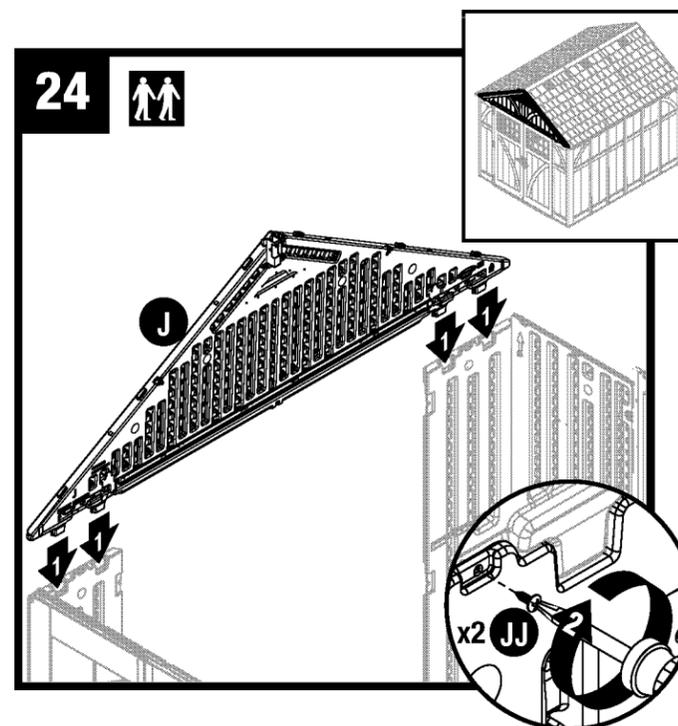
Placez le chevêtre avant (J) au-dessus de l'ouverture de la porte, puis insérez les quatre pieds de support saillants dans les cavités moulées des coins avant. Fixez le chevêtre avant à l'aide de deux vis (JJ).
