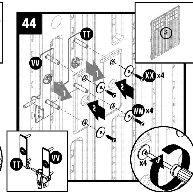
Insérez les tiges des vis des plaques de poignée gauche (TT) et droite (VV) dans les trous pré-perçés des portes. En maintenant les plaques en place à partir de l'extérieur de la porte, fixez chaque plaque à l'aide de deux rondelles (WW) et de deux vis mécaniques (XX).
