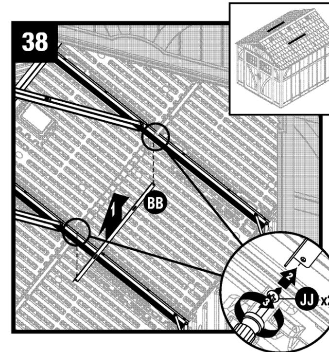
Fixez la rallonge de la barre d'appui du toit (BB) aux chevrons de ferme à l'aide d'une vis (JJ) de chaque côté.
