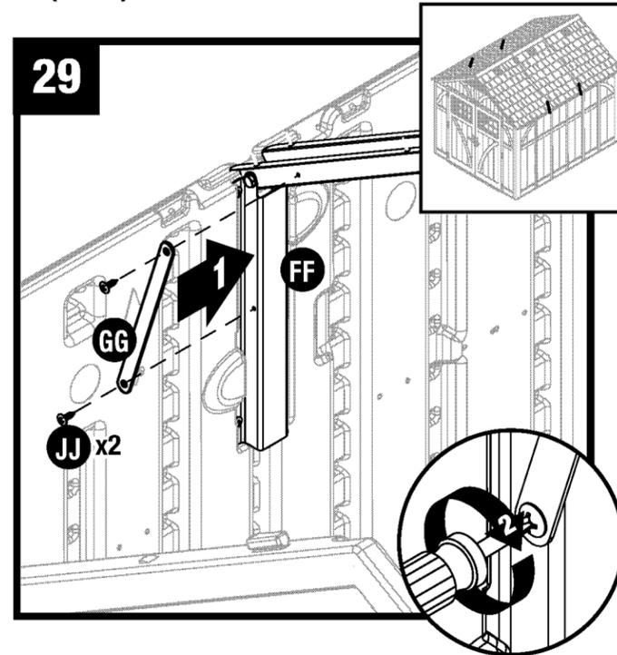
Fixez une armature de ferme (GG) au support d'adaptateur latéral (FF) à l'aide de deux vis (JJ).
