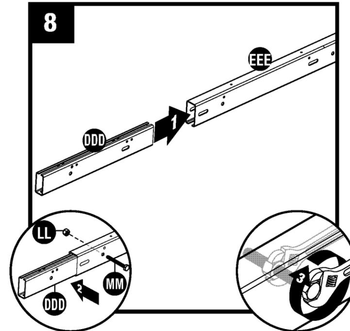
Insérez l'adaptateur du faîtage (DDD) à l'intérieur du faîtage de 0,91 m (3 pi) (EEE). Fixez à l'aide d'un boulon hexagonal (MM) et d'un écrou (LL).
