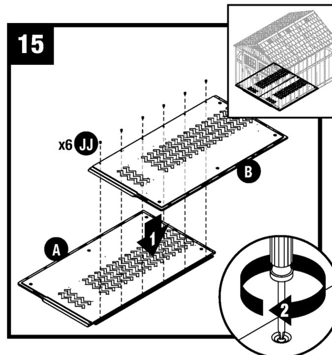
Poussez la partie gauche du plancher (A) vers la partie droite du plancher (B) pour les réunir et fixez-les à l'aide de six vis (JJ).
