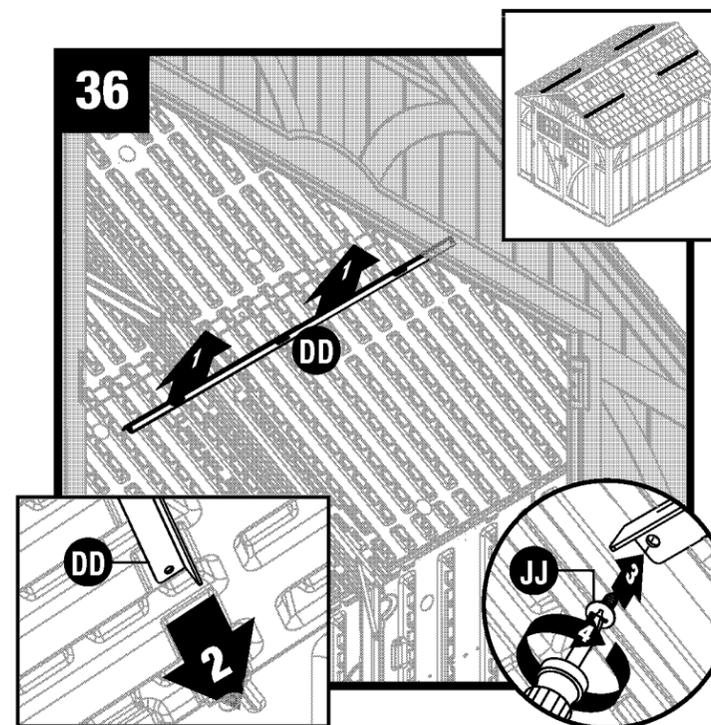
Soulevez la barre d'appui du toit (DD) pour la positionner contre le toit. Faites glisser la barre d'appui du toit (DD) dans le chevêtre avant. Fixez la barre d'appui du toit (DD) au-dessous du chevron de ferme à l'aide d'une vis (JJ).
