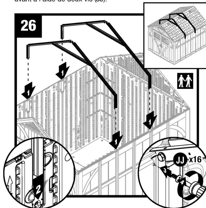
Faites glisser l'assemblage de la ferme pour la mettre en place. Fixez à l'aide de quatre vis (JJ) dans chaque support d'adaptateur latéral.
