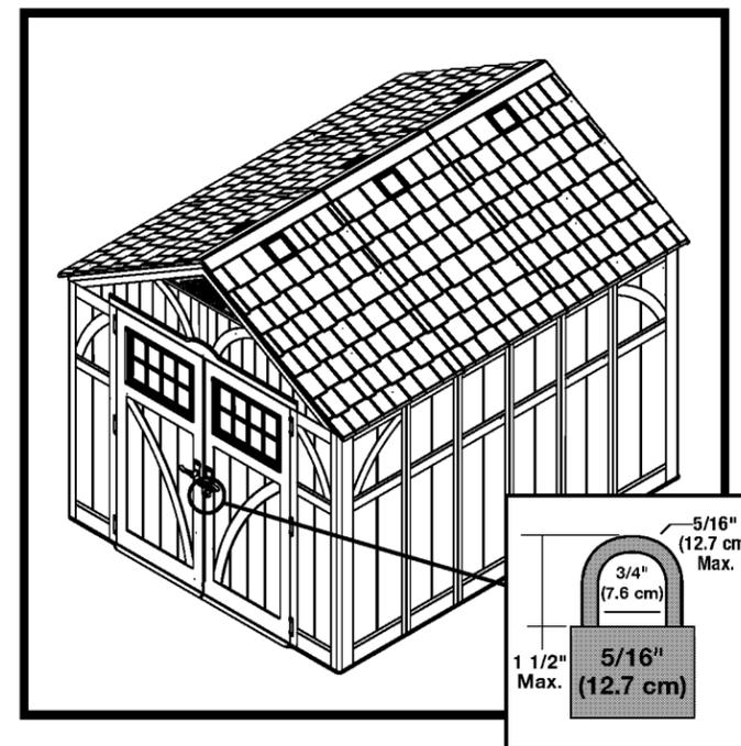
Attacher les poignées de portes ensemble au moyen d'un cadenas de 5/16 po (non compris) pour verrouiller efficacement la remise.
