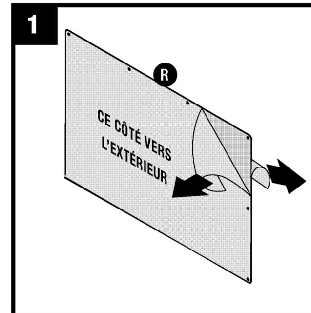
Retirez le film des deux côtés de la fenêtre (R). Retirez également le film protecteur des bords de la porte.
