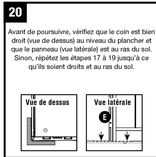
Avant de poursuivre, vérifiez que le coin est bien droit (vue de dessus) au niveau du plancher et que le panneau (vue latérale) est au ras du sol. Sinon, répétez les étapes 17 à 19 jusqu'à ce qu'ils soient droits et au ras du sol.
