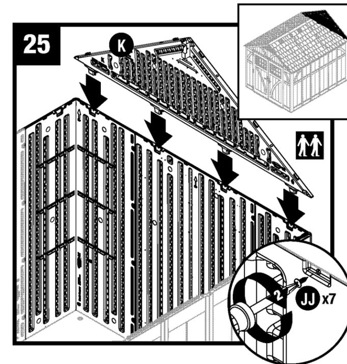
Placez le chevêtre arrière (K) sur les parois arrière et insérez les quatre pieds de support saillants dans les cavités moulées des parois arrière. Fixez le chevêtre arrière à l'aide de huit vis (JJ).
