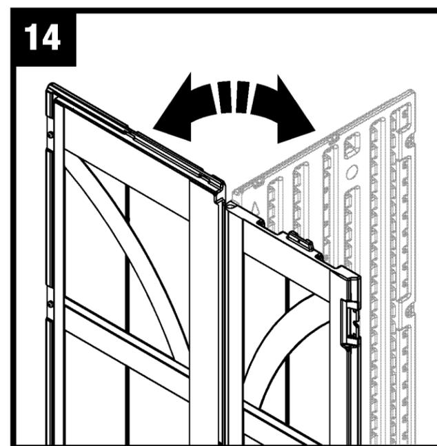
**Très important :** lors de la pose des coins, repliez plusieurs fois les charnières d'angle d'avant en arrière. Ceci vous permettra d'obtenir un angle droit et d'assurer une installation correcte des panneaux restants. **Important :** NE repliez PAS en position inverse, car cela pourrait provoquer une fissure du panneau.
