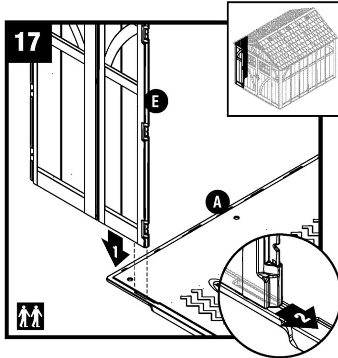
Alignez la languette au bas du coin avant gauche (E) sur la fente de la partie gauche du plancher (A). Abaissez le panneau dans la fente et bloquez-le en le faisant glisser vers l'ouverture de la porte.
