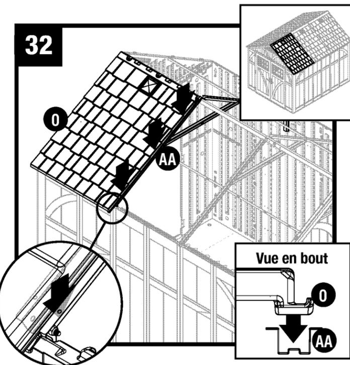
Enfoncez la bordure de la partie droite du toit (O) dans la rainure du chevron de ferme (AA).
