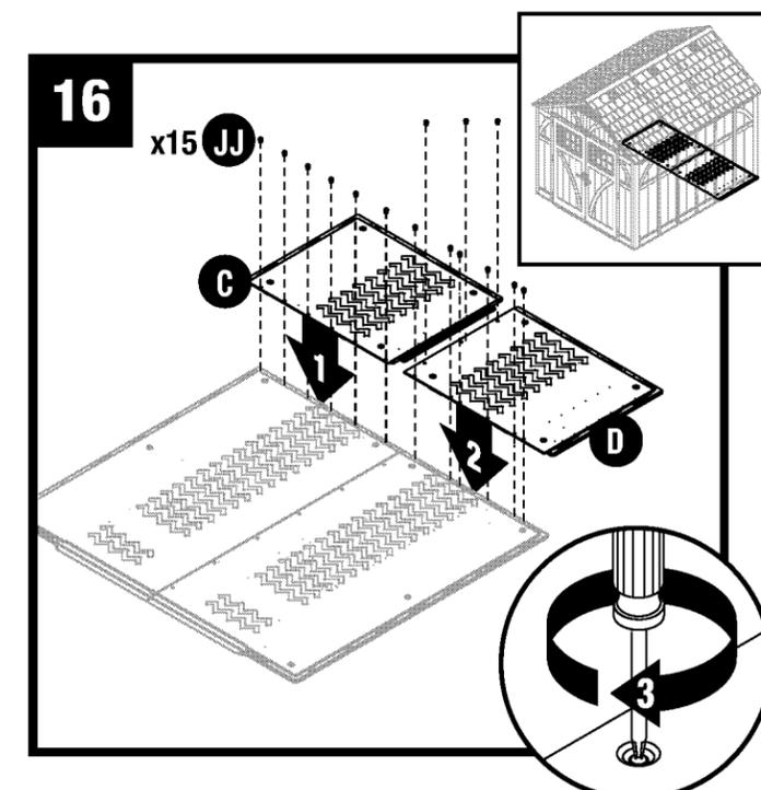
Répétez l'étape 15 pour la rallonge de la partie gauche du plancher (C) et de celle de droite (D). Fixez-les à l'aide de douze (15) vis.
