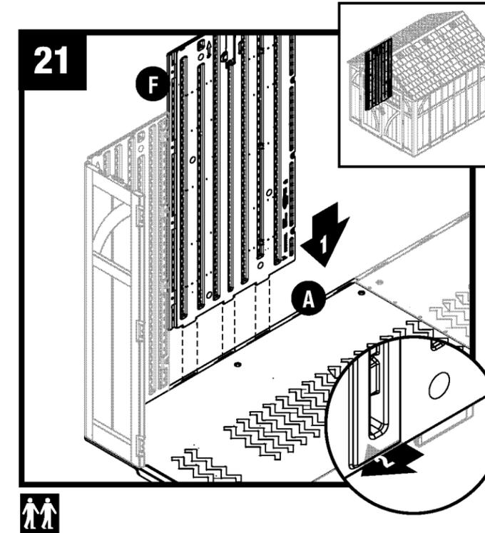
Alignez les languettes situées au bas du panneau latéral (F) sur les fentes du plancher (A). Abaissez le panneau dans les fentes et bloquez-le en le faisant glisser vers le coin avant.
