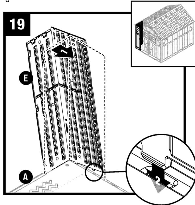
Redressez le coin avant gauche (E) à la verticale et alignez les languettes inférieures du côté droit sur les fentes du plancher.
