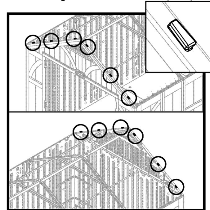
Avant de poursuivre, repérez et identifiez les six languettes du chevêtre avant et les six languettes du chevêtre arrière.
