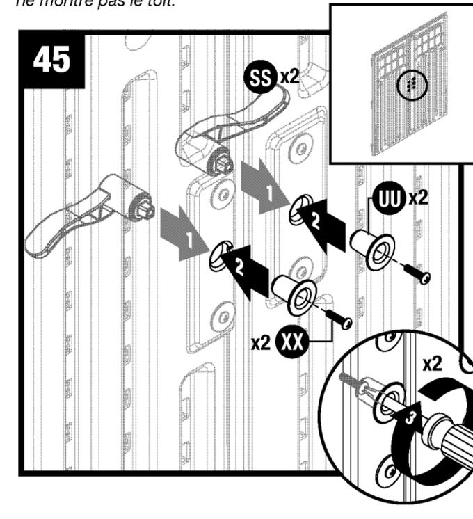
À partir de l'extérieur des portes, insérez les poignées de porte (SS) dans les trous pourvus à cet effet. À l'intérieur des portes, placez les entretoises (UU) sur chaque poignée et fixez-les avec d'une vis mécanique (XX).
