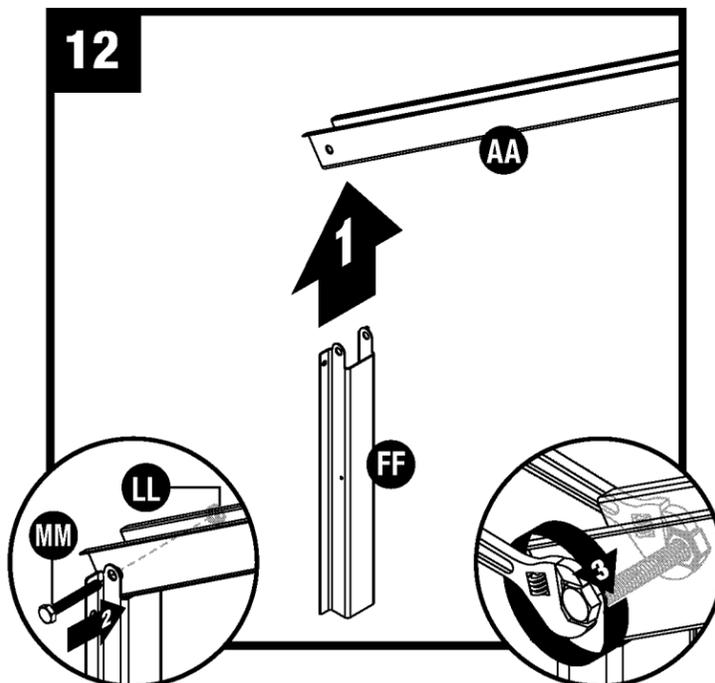
Fixez le support d'adaptateur latéral (FF) à l'extrémité du chevron de ferme gauche (AA) à l'aide d'une vis à tête hexagonale (MM) et d'un écrou (LL). Faites de même pour l'autre support d'adaptateur latéral (FF).
