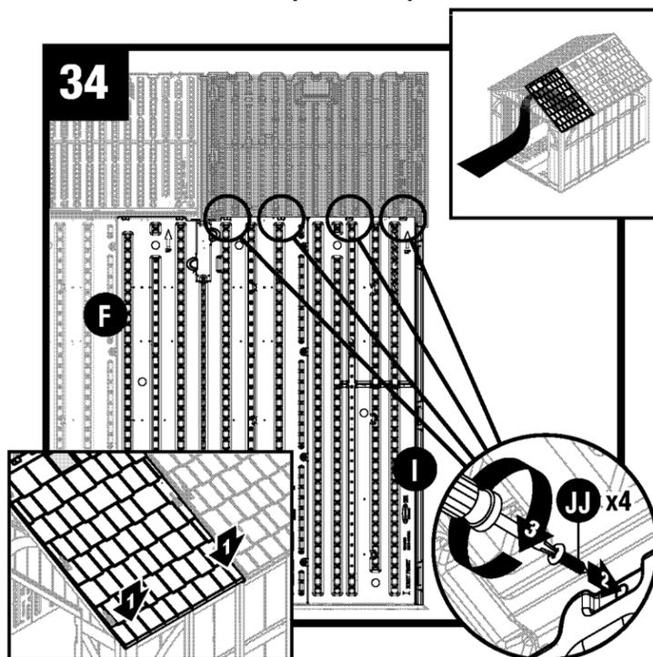
Appuyez sur chaque coin inférieur du toit, depuis l'extérieur. À l'intérieur de la remise, fixez les languettes du coin avant droit (I) et du panneau latéral (F) au panneau du toit à l'aide de quatre vis (JJ).
