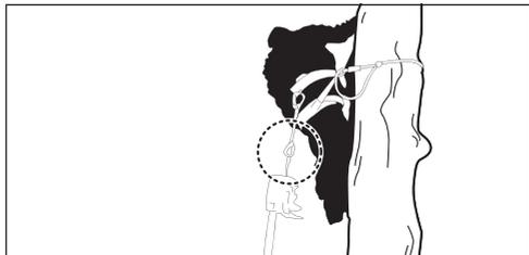
Lorsqu'il déplace le produit d'un point d'attache à un autre, l'opérateur doit s'assurer que le produit est bien fixé dans sa nouvelle position avant de le détacher du point d'attache précédent.
