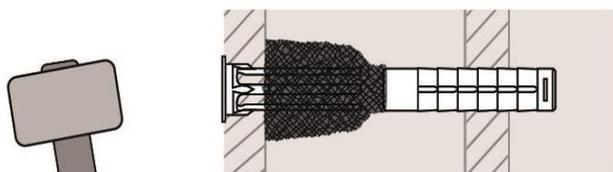
■ Insérer le système EASYMIX jusqu'à ce que la collerette vienne se plaquer sur la paroi extérieure de la maçonnerie. Utiliser un marteau si nécessaire.
