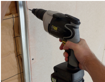
Butée de profondeur réglable Adjustable depth gauge
