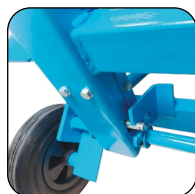
Interverrouillage du chariot de coupe et du protecteur supérieur.
