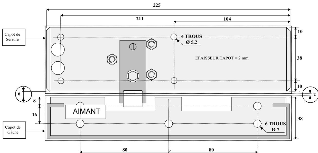
**PLAN DE FIXATION DES PLAQUES DE BASE ET DES EQUERRES DE GACHE DU VERROU 2 VANTAUX (EN MM)**
