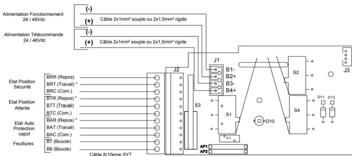
*Note : pour le modèle 2 vantaux, prévoir le raccordement de 2 cartes.*
