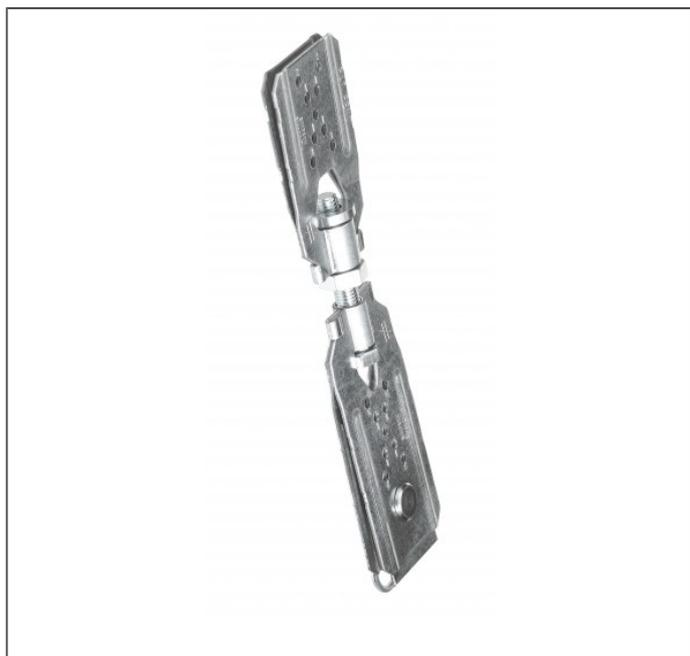
Les tendeurs de feuillards facilitent la mise en oeuvre des feuillards sur le chantier. Ils permettent d'obtenir une pose conforme aux spécifications de tensions exigées pour ce type de contreventement. Le réglage est réalisé avec une clé plate.
