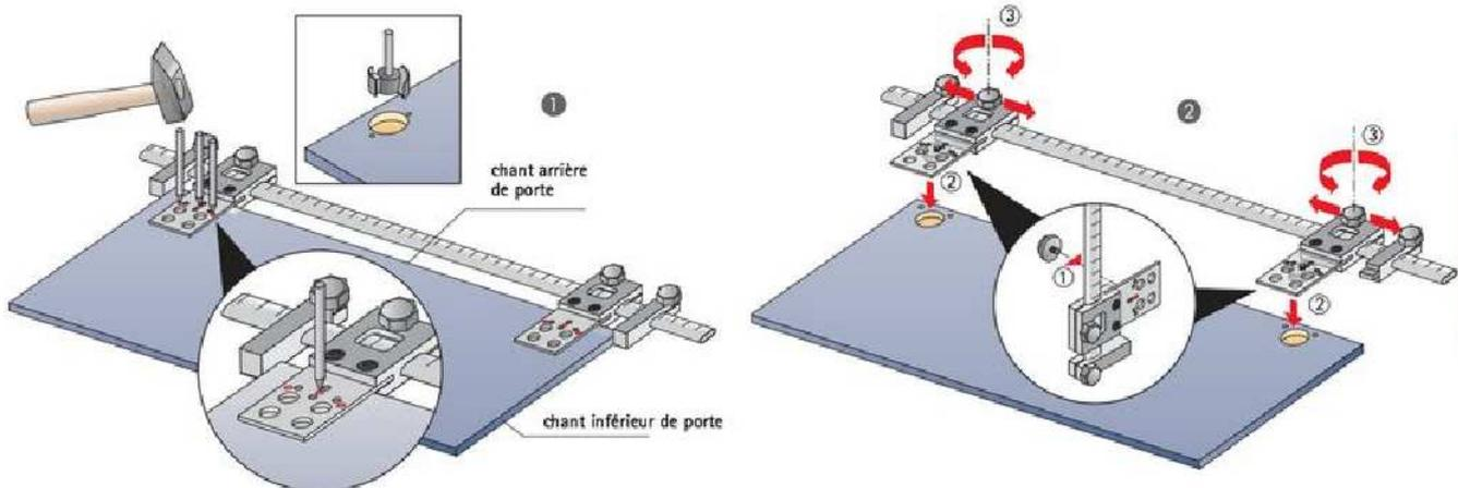
1 Ajuster la plaque de perçage et la butée réglable. Pointer les perçages correspondants aux différents types de charnières à l'aide du poinçon de centrage. Effectuer les perçages de boîtier pour les charnières.
