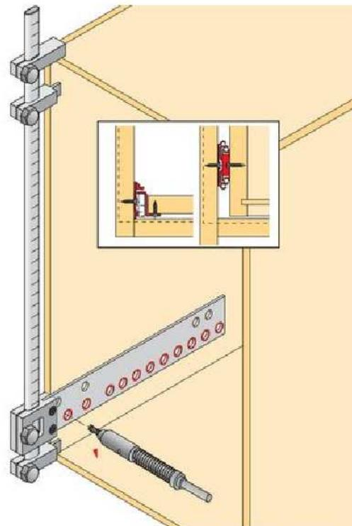
2 La butée réglable est fixée "à fleur" avec le rail : la fenêtre pratiquée dans la plaque de perçage permet de lire avec précision les positions de vissage des différents dispositifs de coulissage sur la graduation du rail.
