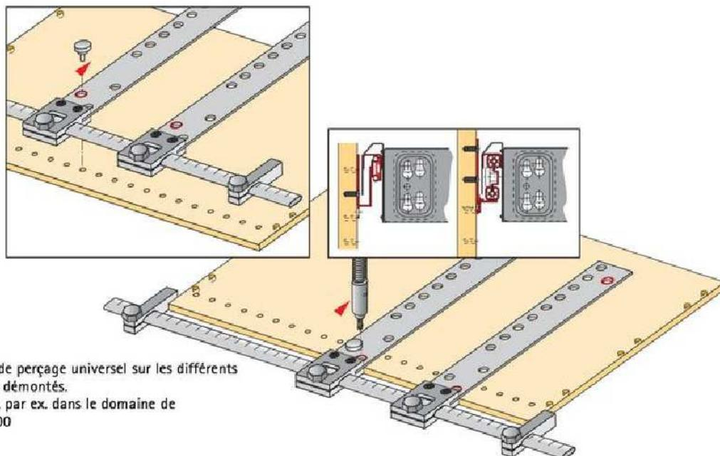
3 Pose du gabarit de perçage universel sur les différents côtés de caisson démontés. Très avantageux, par ex. dans le domaine de Systema Top 2000
