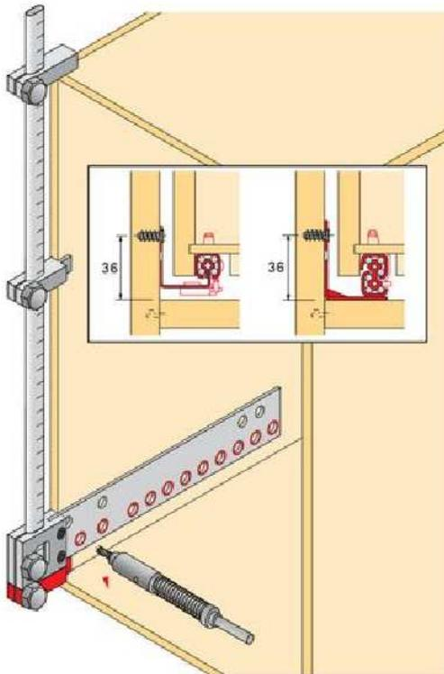
1 La plaque de perçage et la butée réglable se trouvent à la base, permettant ainsi d'utiliser au choix des coulisses à Quadro 30 sortie partielle et des coulisses à Quadro V6 sortie totale en conservant la même position de tiroir/façade.
