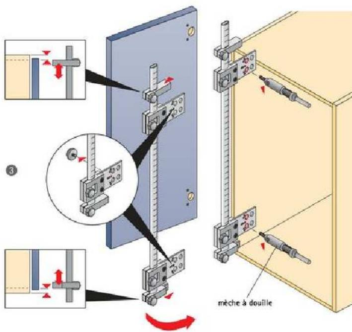
3 Retirer les gabarits de boîtiers et positionner le gabarit de perçage selon les cas dans le caisson. Effectuer les perçages des embases directement à l'aide des mèches à douilles.
