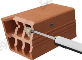
4. Dévisser le bouchon. Placer la cartouche. Visser la buse. Introduire la buse au fond du tamis puis reculer le pistolet de une graduation sur la buse entre chaque pression sur la poignée.
