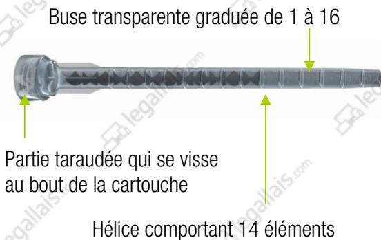
Elle se visse à l'extrémité de la cartouche. Elle comprend un élément hélicoïdal noir pour le mélange et des graduations de repérage pour la mise en œuvre avec le tamis.
