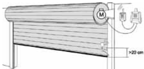
Exemple d’installation sur porte enroulable avec armoire de commande et RADIOBANDRU
