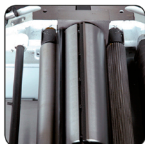
Arbre de dégauchissage de ø 75 mm avec 3 fers 250x 30 x 3
