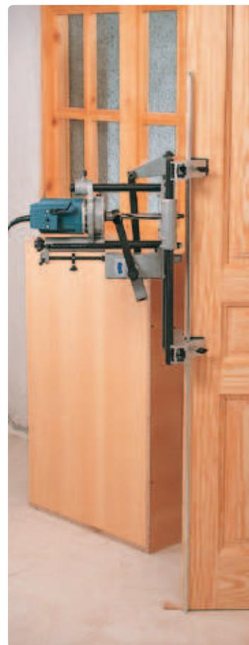
La FC16S est pourvue d'une règle butée se fixant sur la machine, permettant un réglage soit par rapport au sol, soit par rapport au dessus de la porte. Cette possibilité permet de travailler toujours à la même hauteur pour des usinages identiques.
