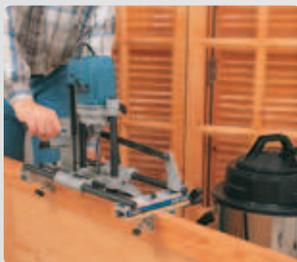
Possibilité de travailler en position horizontale. Pour réaliser des mortaises en série, sur des portes démontées (aspiration indispensable).
