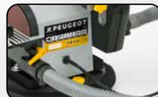
2 buses d'évacuation des poussières 2 Dust collector nozzles
