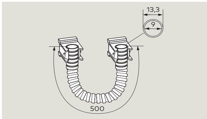
La gaine de protection pour câble dormakaba offre une solution sûre pour amener les conducteurs nécessaires en cas de montage sur vantail.
