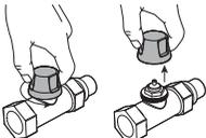
B- Thermoelektrischer Stellantrieb auf das Ventil montieren. (Stehend, senkrecht oder waagrecht).
