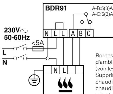
Bornes du thermostat d'ambiance de la chaudière (voir les instructions). Supprimer la liaison de la chaudière si présente. Si la chaudière est équipée d'une minuterie intégrée, laissez-la sur une valeur constante.
