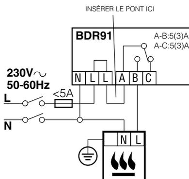
**Figure 4** : chaudière nécessitant une alimentation électrique permanente
