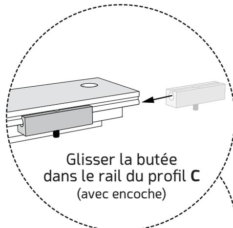
Glisser la butée dans le rail du profil C (avec encoche)
