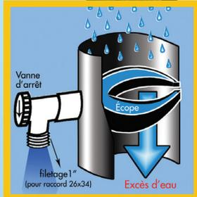
L'eau qui descend dans votre gouttière est centrifugée le long des parois, ce qui permet d'en récupérer la presque totalité lors de faibles précipitations. Par pluies plus importantes, le débit est limité par la section du robinet et le surplus s'évacue au centre de l'écope.
