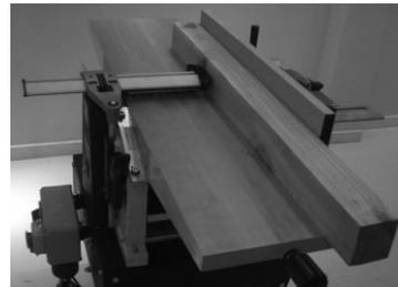
Ajuste el selector de funciones (87) "cepillado" (dibujo a la izquierda del cero). Encender la máquina pulsando el botón verde en el interruptor (88). La parada se realiza presionando el botón rojo.
