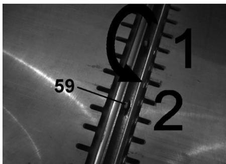
Aflojar los 4 tornillos de cabeza hexagonal (59) con el fin de apretar lo suficiente el porta cuchillas: comenzar con los 2 tornillos del centro (1) y (2), a continuación, terminar con los tornillos de cada extremo.
