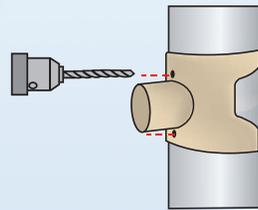
3. Fixer le collier au moyen des 2 vis autoforeuses. (sur conduit zinc ou cuivre, il est conseillé de faire un pré-trou de 2m/m).
