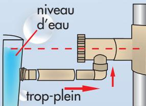
5. Placer le coude sur le robinet. Fixer l'embout à la cuve. Relier l'embout au coude avec le tuyau.
