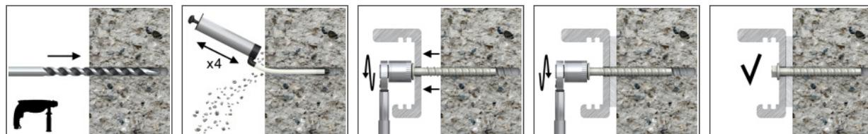
1. Percer le trou à l'aide d'une perceuse à percussion. Percer à la profondeur requise.
