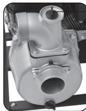
Couvercle de remplissage de la motopompe avec de l'eau
