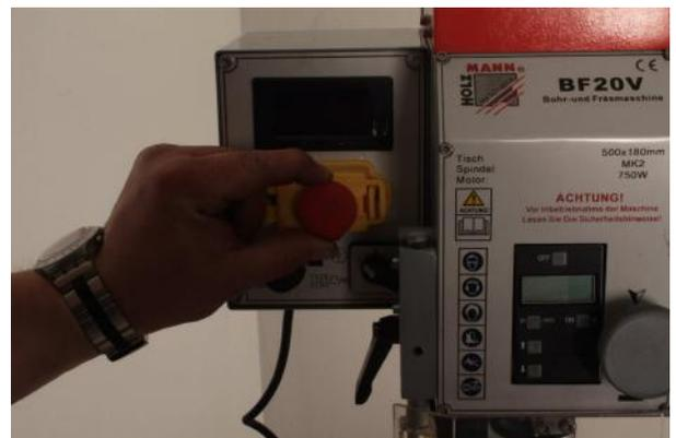
**ALLUMAGE:** Connexion de la machine au secteur électrique.
