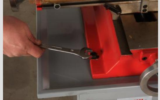
Boulonner la BF20V avec les 4 boulons fournis, au socle. Les orifices ne sont faits. Il faudra **LES PERCER SUR PLACE**.
