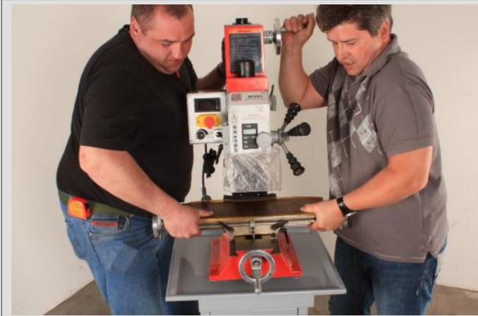
A deux personnes, soulever la machine et la déposer sur le socle (voir photo). S'assurer que la table transversale est bloquée par les manettes 5 et 5a.
