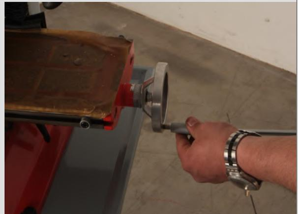
Monter la poignet au volant droite /gauche pour l'alimentation X. Une fois fait, débloquer la table, retirer le film protecteur et nettoyer la machine avec un détergent doux.
