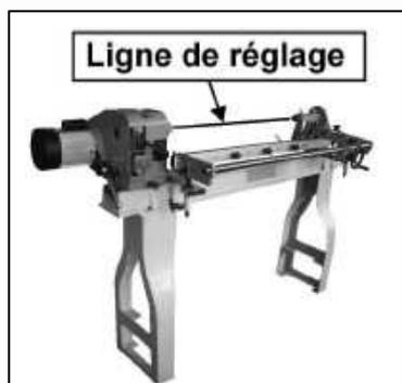
1° Horizontalement, le copieur (barre de chariotage crantée et tube de chariotage carré) doit être parallèle au banc du tour.
