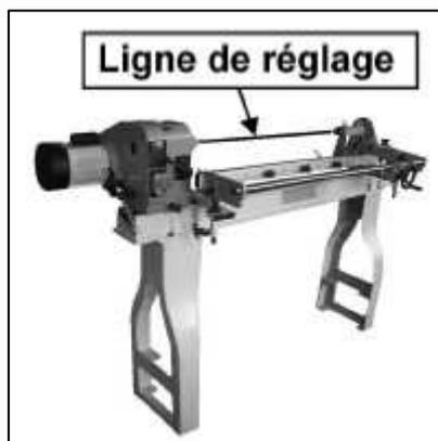
1° Verticalement, le copieur (barre de chariotage crantée et tube de chariotage carré) doit être parallèle au banc du tour.
