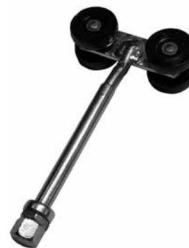
Les chariots, quand appliqués pour cadres en aluminium, sont conçus pour une combinaison avec des charnières de 16mm et 20mm de distance entre axe, et disponibles en inox ou en acier galvanisé, toujours avec roulettes en matière synthétique. Ces dernières sont montées sur roulements à billes étanches qui garantissent un fonctionnement souple et silencieux.
