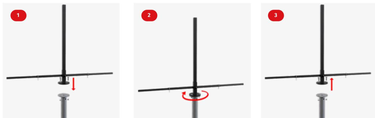
**1. Connecter l'outil** sur le disque de la vis de fondation à l'aide des 3 écrous fournis
