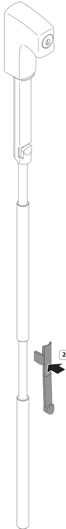
**3** Placer la pièce sur le corps, puis fixer le tout sur votre porte (nous conseillons une fixation par vis M5 avec écrous à sertir non fournies) ;
