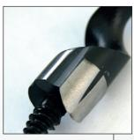
La tête de perçage décolletée évite l'échauffement de la mèche et donc le frottement derrière celle-ci durant le perçage tout en réduisant par la même occasion la charge sur la machine. L'évacuation facile des copeaux permet des vitesses de rotation plus élevées que sur les mèches standards.
