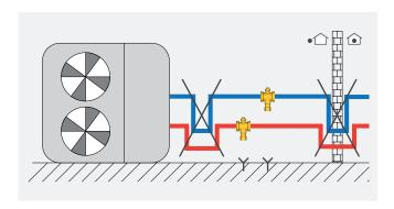
La vanne de protection contre le gel doit être installée :
