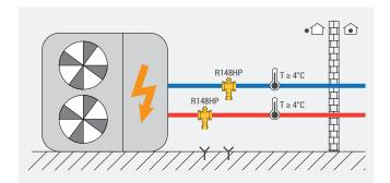
Lorsque la température du fluide caloporteur baisse et atteint 1 °C, la vanne s'ouvre et évacue le fluide de manière à éviter la formation de glace à l'intérieur des canalisations.
