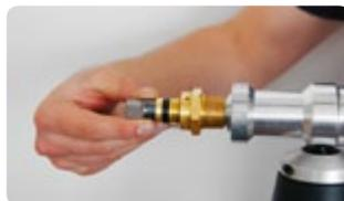
Enfoncer le tuyau FLEXIPIPE élargi sur le raccord FLEXISERT à travers l'insert et le raccord FLEXISERT jusqu'à la butée :
