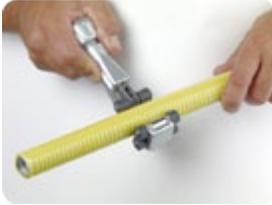
Coupe du tuyau FLEXIPIPE avec coupe-tube adapté
