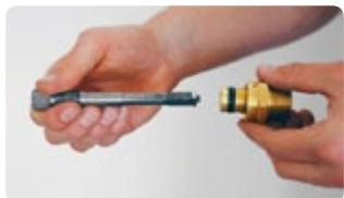
Sélectionner l'insert adapté au FLEXISERT et l'enfoncer jusqu'à butée
