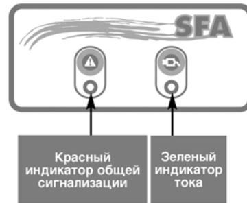
Удаленный пульт аварийной сигнализации SANICUBIC® 1 не нуждается в независимой подаче электропитания. Электропитание на пульт SANICUBIC® 1 подается через электронную плату. В случае перебоев в электросети питание будет подключено от батареи.
